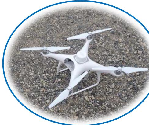
航行ルートをプログラムした小型ドローンを飛ばします。自律制御で等間隔に空撮します。
